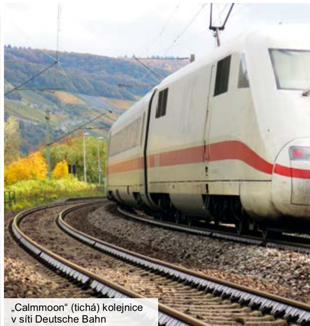
Detail odhlučnění stojky kolejnice „Calmmoon“
